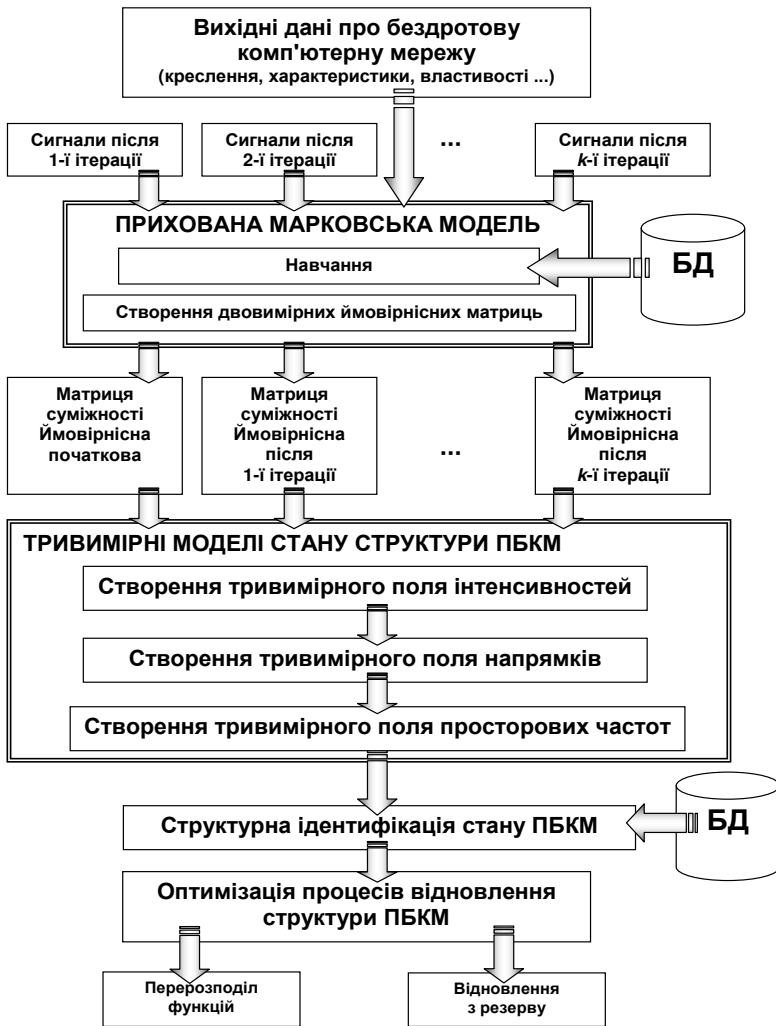
Рисунок 11 – Структура системи «OBMIN» розпізнавання та відновлення структури ПБКМ
