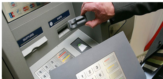
Рис. 1. Накладні клавіатури, та спеціальний пристрій (скімер).
