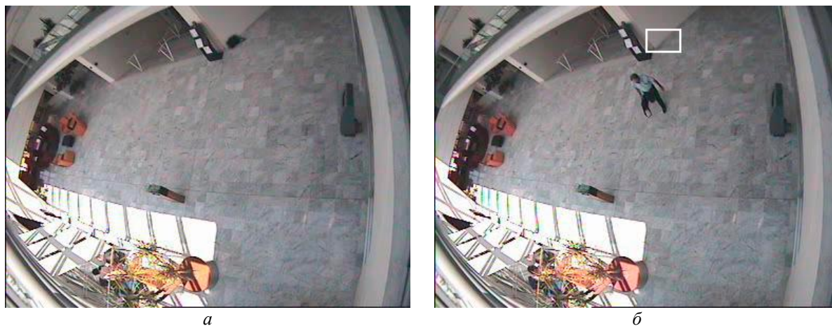
Рис. 3. Результат работы системы: а — фоновое изображение; б — текущий кадр, на котором человек забрал предмет
