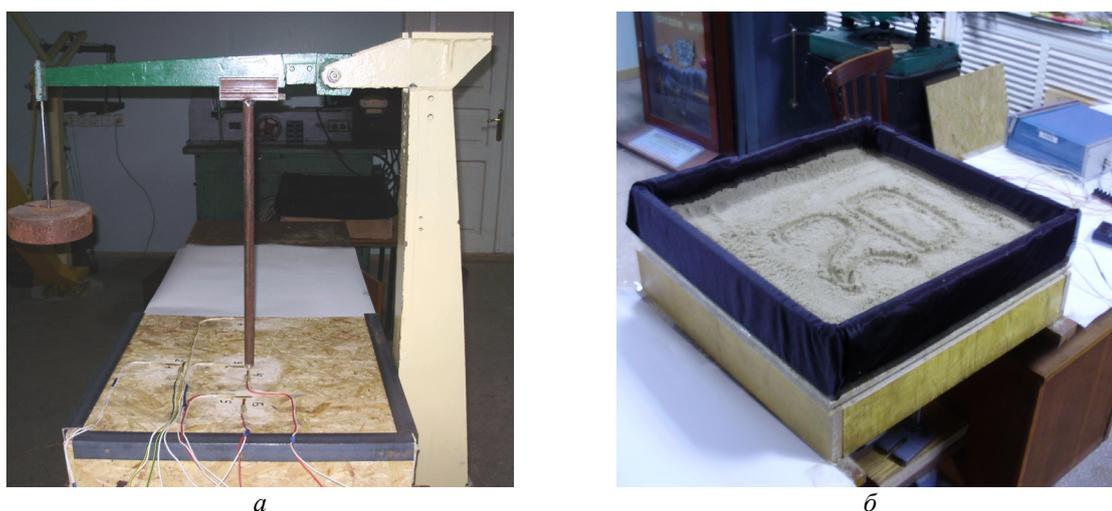
Рис. 3. Нагружение пластины сосредоточенной силой (а) и распределенной нагрузкой (б)
