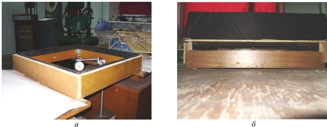
Рис. 1. Испытательные стенды: имитация шарнирного опирания по всему контуру (а), имитация условий жесткого защемления по трем сторонам и одной свободной грани (б)
