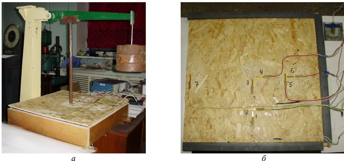
Рис. 2. Размещение тензодатчиков: при шарнирном опирании пластины по всему контуру (а), при жестком защемлении пластины по трем сторонам и одной свободной грани (б)
