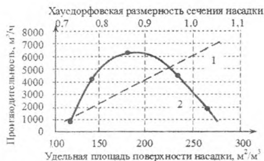
Рис. 4. Теоретическая (1) и реальная (2) зависимости интенсивности абсорбции от площади поверхности насадки
