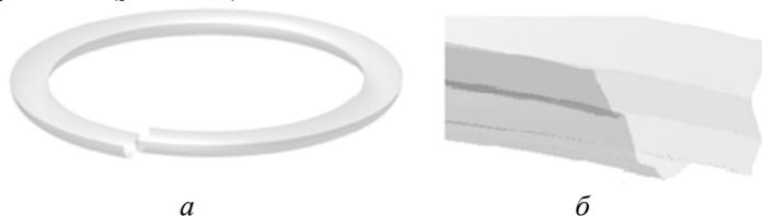
Рис. 3. Траектория перемещения кромки абразивного зерна: круглого, за один оборот (а); неправильного многоугольника (фрагмент траектории)(б)
