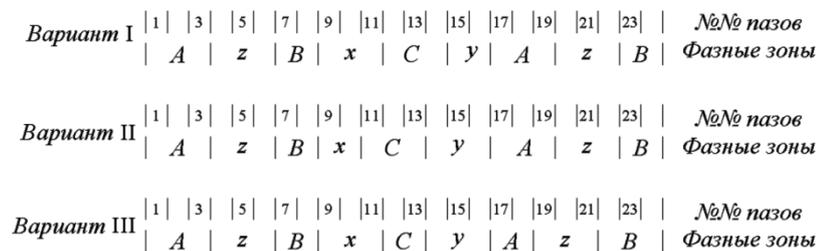
Рис. 1. Распределение фазных зон 1/2 обмотки с числом полюсов и пазов соответственно  $2p = 6$ ,  $Z = 48$
