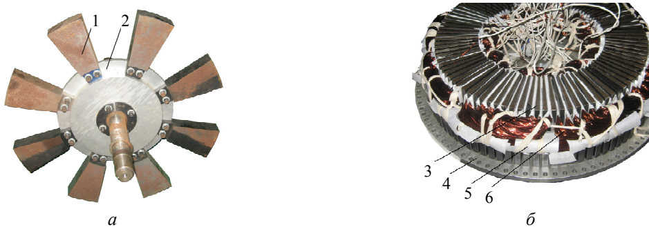
Рис. 1. Двигатель постоянного тока с безобмоточным ротором: ротор(а), статор(б)
