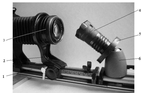
Рисунок 3 – Фрагмент стенда для предварительного лабораторного анализа состояний режущей части СГС (1 – корпус, 2 – стойки крепления оптики, 3 – окуляр, 4 – головка ВТА, 5 – поворотный диск для вращения головки вокруг оси, 6 – устройство для вспомогательных поворотов головки).
