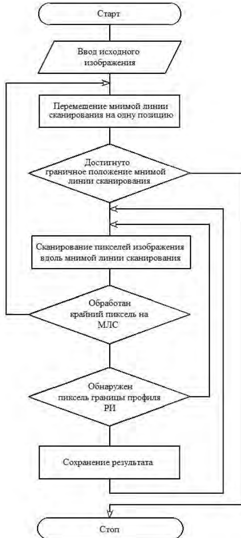
Рисунок 4 – Блок-схема алгоритма выделения контура РК резца по цифровому изображению его передней поверхности
