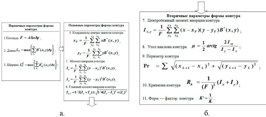
Рисунок 1 – Некоторые из зависимостей для определения первичных, основных (а) и вторичных (б) признаков формы контуров поверхностных дефектов и компонентов структур материалов
