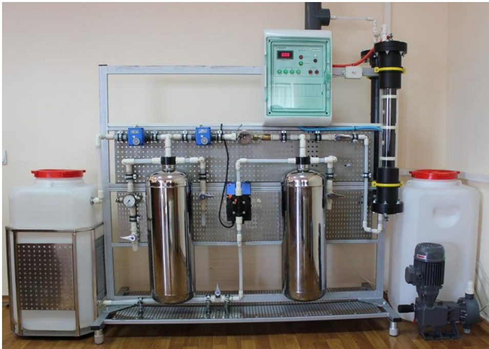
Рис. 5.3 – Установа для одержання електролізного натрію гіпохлориту
