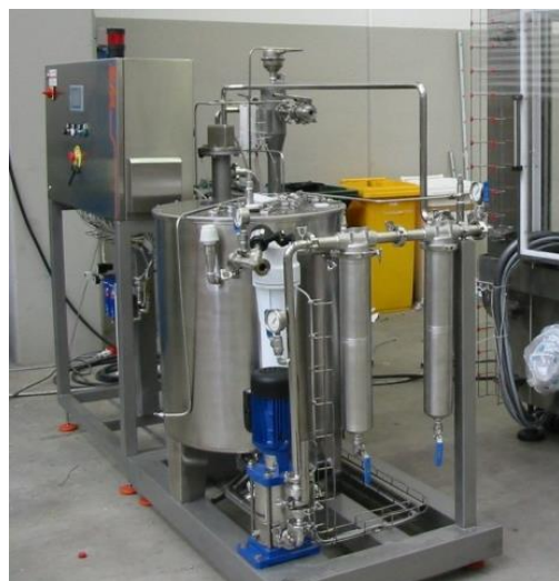
Рис. 5.4 – Установки для одержання озону та озонування води
