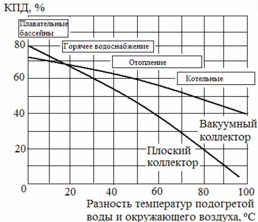
Рисунок 1.7 – Области применения солнечных водоподогревателей и зависимость КПД плоского и вакуумного солнечных коллекторов от разности температур подогретого теплоносителя и окружающего воздуха
