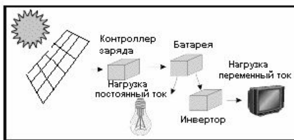
Рисунок 1.3 - Принципиальная схема полупроводниковой электростанции
