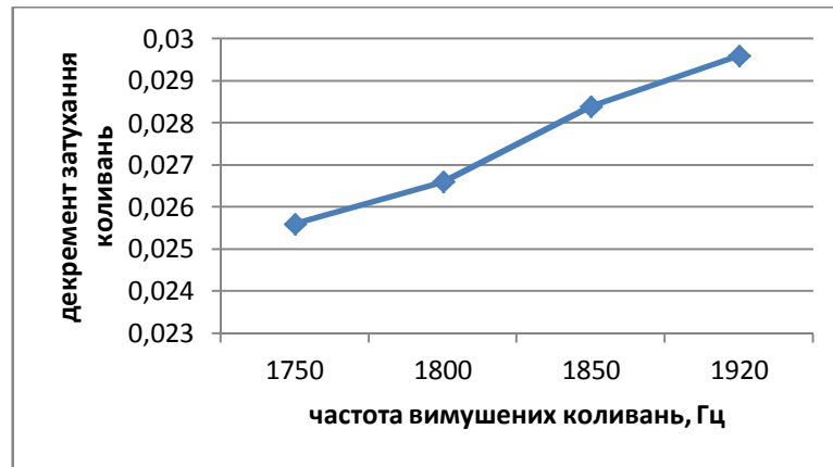
Рисунок 3 – Залежність декременту затування коливань від частоти
