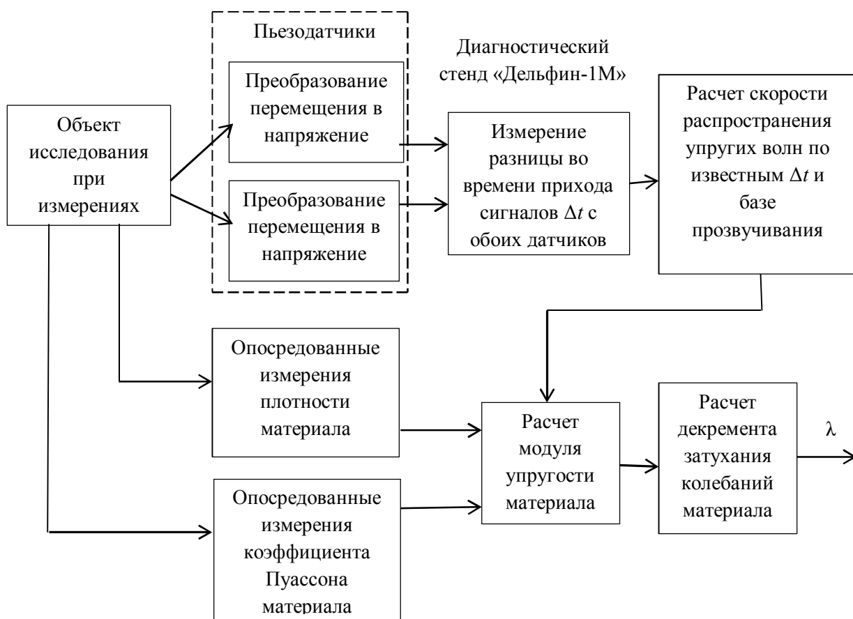
Рисунок 2 - Блок-схема преобразований измеряемой величины в акустическом методе измерения диссипативных свойств неметаллических гетерогенных материалов
