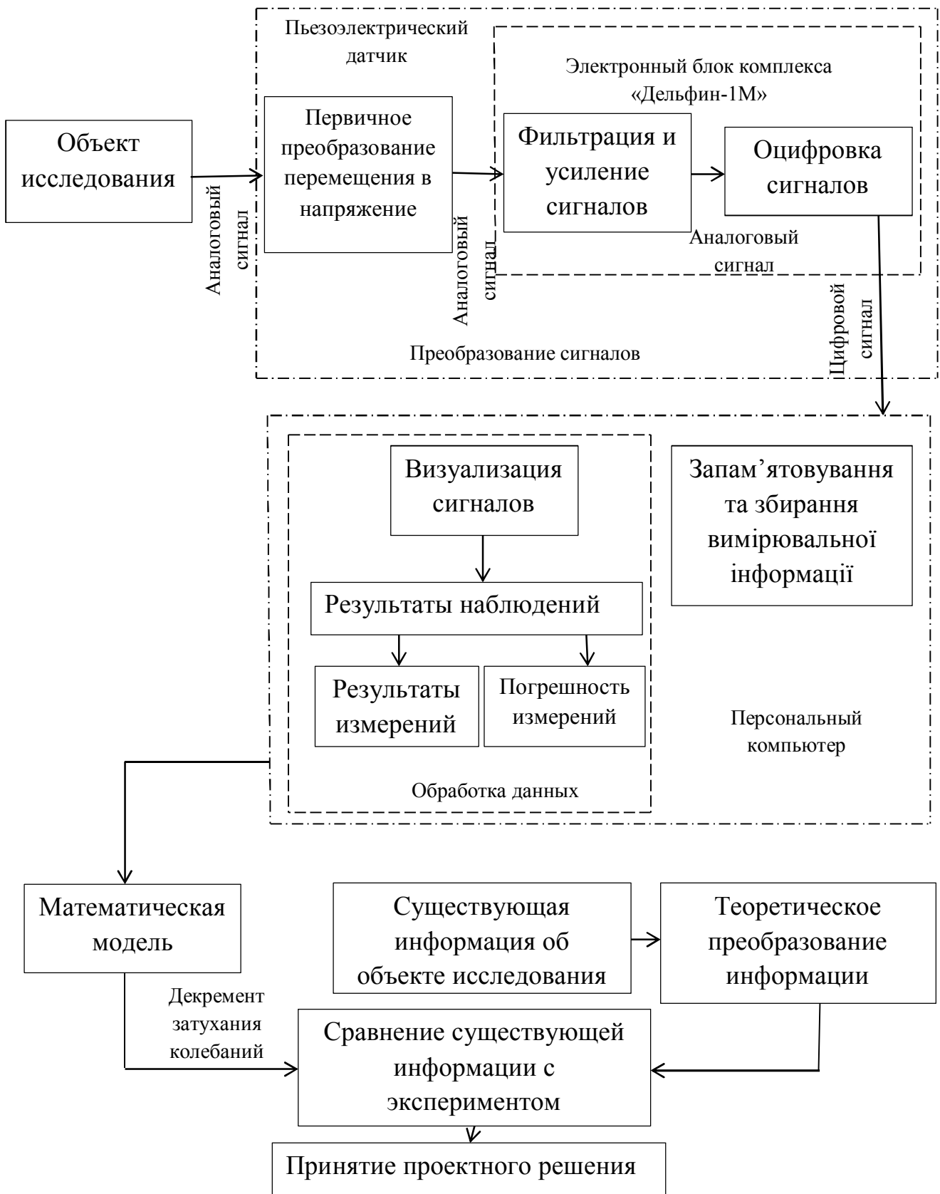
Рисунок 3 - Структурная схема измерительной системы для определения декремента затухания колебаний в неметаллических гетерогенных материалах
