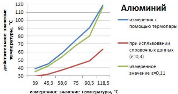
Рисунок 1 – Влияние коэффициента излучательной способности на точность бесконтактного метода измерения температуры меди и алюминия
