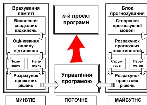
Рис. 3 – Схема системи підтримки поточних проектних рішень із врахуванням спадкової пам'яті (минулі проекти) та прогнозу (стан продукту поточного проекту)
