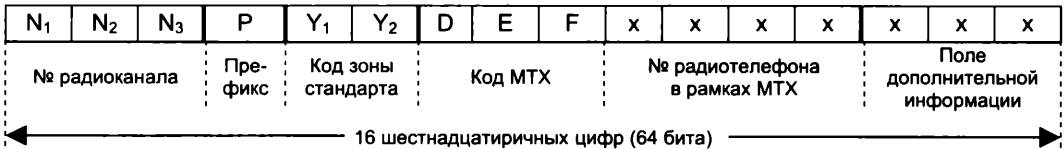
Рис. 10.6. Формат информационной части сигнального кадра
