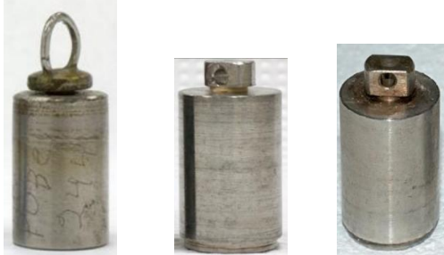
Рисунок 1. Общій вид нейтронних джерел S1, S2, S3 [7]
