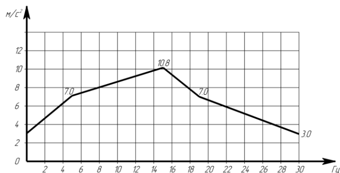
Рисунок 7. Обобщенный спектр ответа при вертикальных колебаниях реакторного отделения на отметках (+36,900; +40,900) (МРЗ – 7 баллов)
