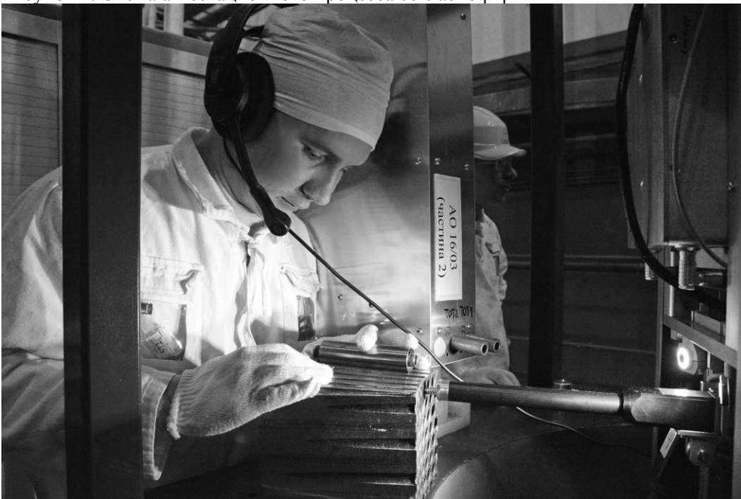
Рисунок 3. Проведение практических испытаний на открытых тест-образцах для аттестации оборудования и методик контроля
