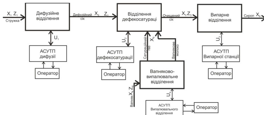
Рисунок 1 – Структурна схема управління а також матеріальні потоки станції дефекосатурації і суміжних ділянок
