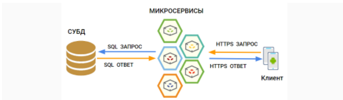
Рис. 1 – Схема работы трехзвенной архитектуры
