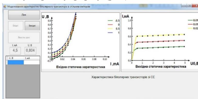
Рис. 1 Екранна форма: температурна залежність вхідних та вихідних характеристик біполярного транзистора в схемі із загальним емітером.
