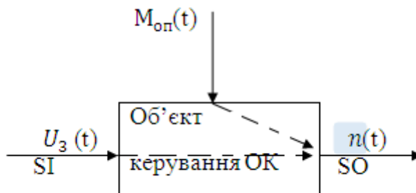
Рисунок 2 - Модель «вхід-вихід» об'єкта керування типу SI- SO
