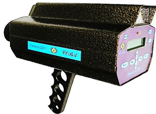
Рисунок 1 – Пристрій для безконтактного вимірювання температури поверхні нагрітих тіл [4]
