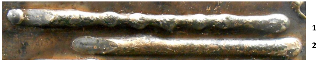
Рис.5. Валики, наплавленые самозащитной электродной проволокой диаметром 1,6 мм на вертикальной плоскости (ток 230 А; напряжение 28 В) с применением подачи: 1-непрерывной; 2-дозированной
