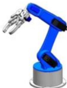
Рис. 5. Манипулятор виготовлений за допомогою 3D-принтера
