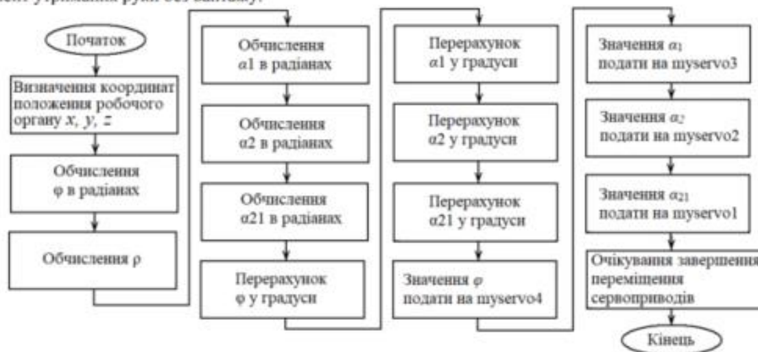
Рис. 13. Алгоритм керування переміщенням маніпулятора
