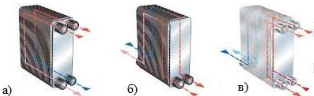
Рис 7. Конструкція пластинчастого теплообмінника за кількістю ходів
