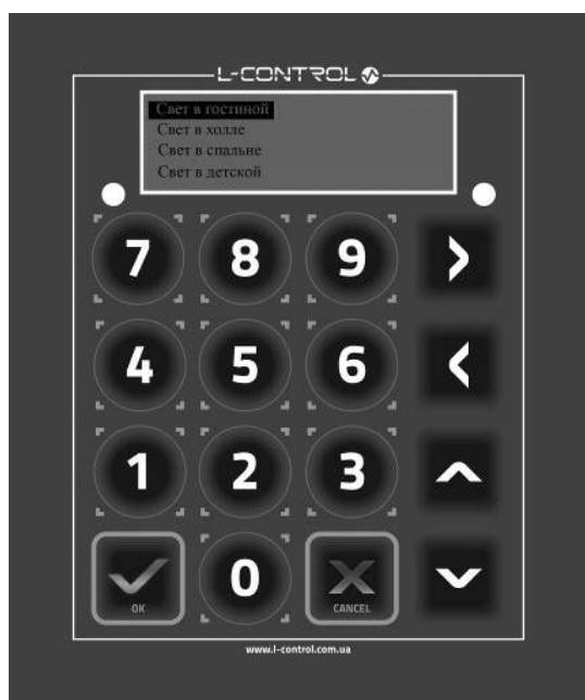
Рис. 1. Проводной блок управления системой «Умный дом»
