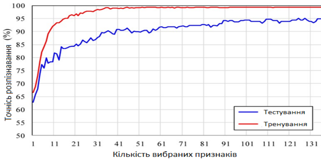
Рисунок 2.3 – Зміна точності розпізнавання відповідно до кількості вибраних ознак класифікатора
