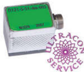
Рисунок 3.1 – Зовнішній вигляд п'єзоелектричного перетворювача
