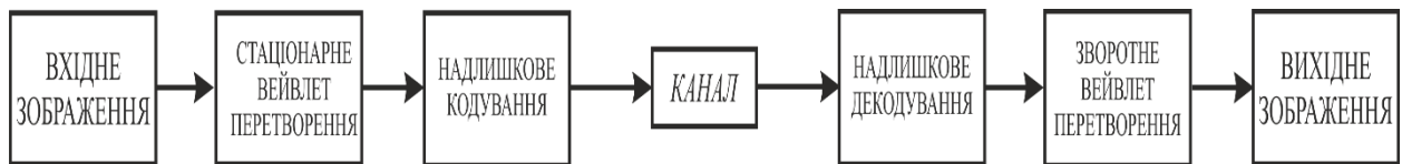
Рисунок 2.1 - Структурна схема кодування зображень
