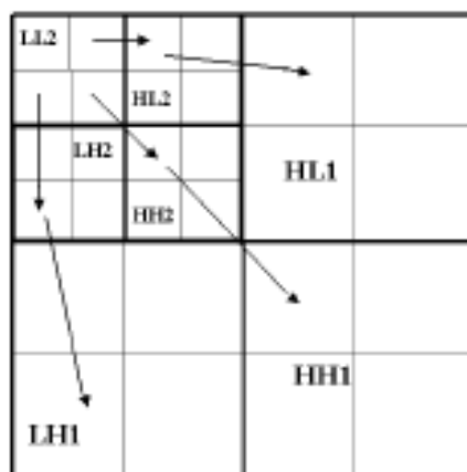
Рисунок 2.2 - Кодування вейвлет-коефіцієнтів нуля-деревом
