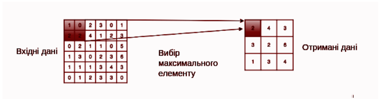
Рисунок 2.8 – Робота субдискретизуючого шару нейронної мережі
