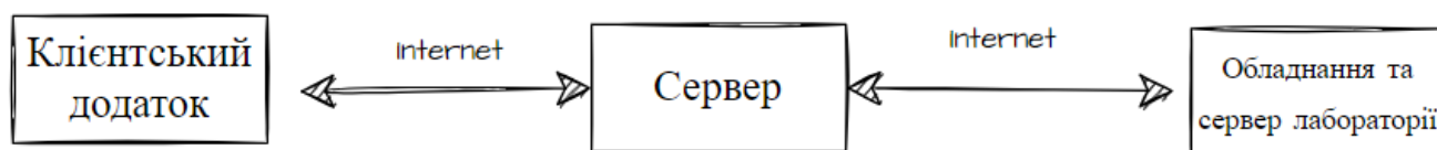
Рисунок 1.1. - Загальна архітектура iLab системи GOLDI
