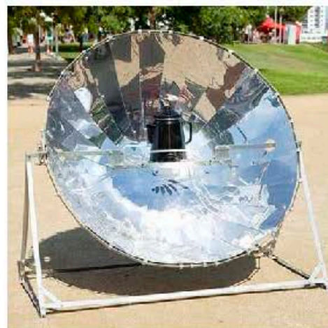
Рис 4.3 – Сонячна піч з параболічним концентратором
