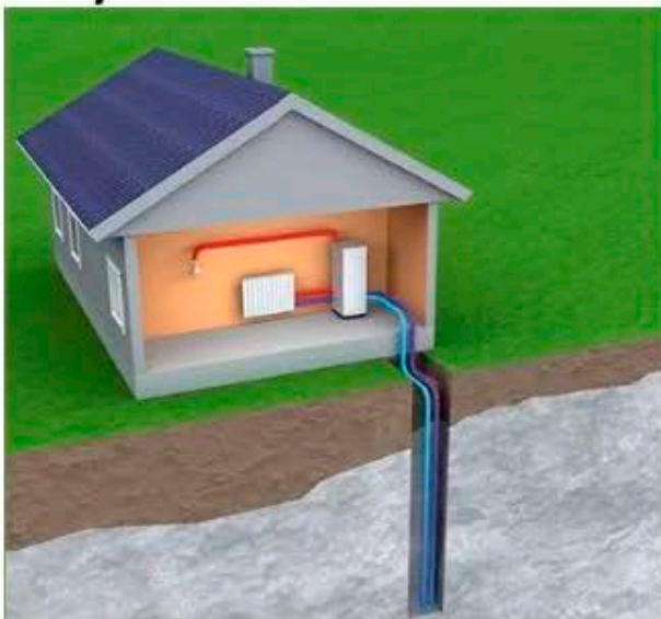
Рис 11.2 – Грунтовий тепловий насос (вертикальне та горизонтальне розрашування трубок)
