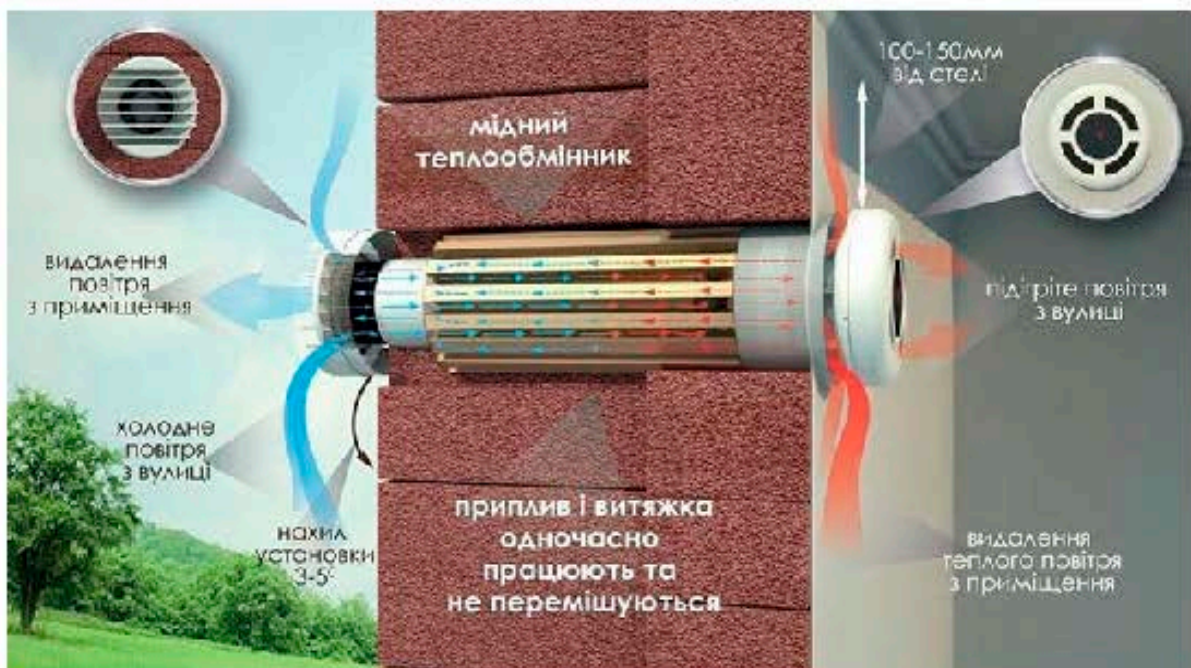
Рис 12.4 – Трубчасті рекуператори
