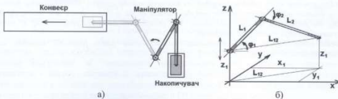
Рис. 1. Робот для переміщення фотоелементів з накопичувача на конвеєр: а – ділянка переміщення фотоелементів; б – кінематична схема маніпулятора
