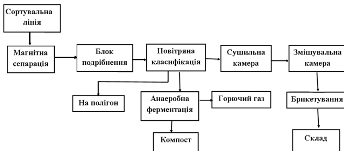
Рис.2 Принципова схема утилізації твердих побутових відходів з виробництвом палив з наперед заданими теплотехнічними характеристиками
