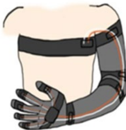
Рисунок 1 – Схема конструкції рукавички для дистанційного керування маніпулятором.
