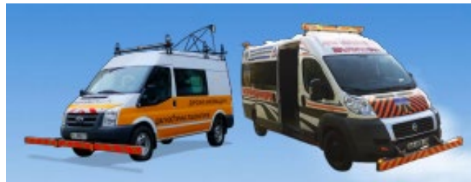
Рисунок 2 - Пересувні лабораторії розробки ХНАДУ з системами відео діагностики
