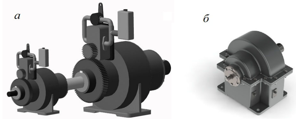
Рисунок 6 - Моделі пристроїв керування змінами швидкості за допомогою двоступеневого диференціала і замкнутих гідросистем через водило
