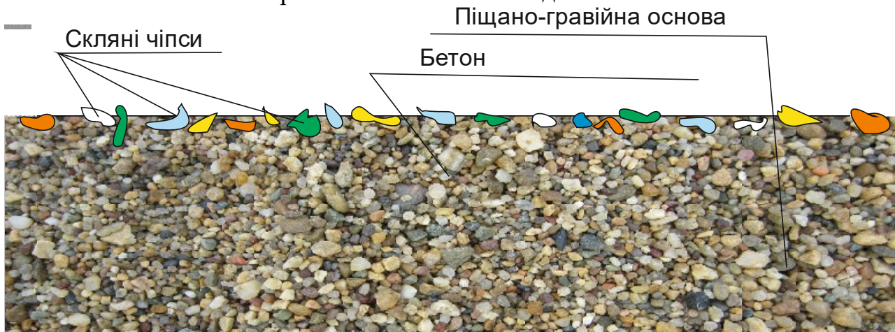
Рисунок 2. Улаштування поверхні тераццо методом розкидання скляного заповнювачу по поверхні
