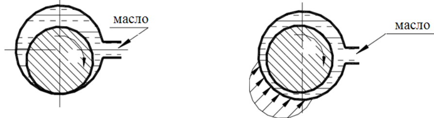
Рисунок 1. Схема роботи гідростатичного плаваючого вкладиша підшипника ковзання
