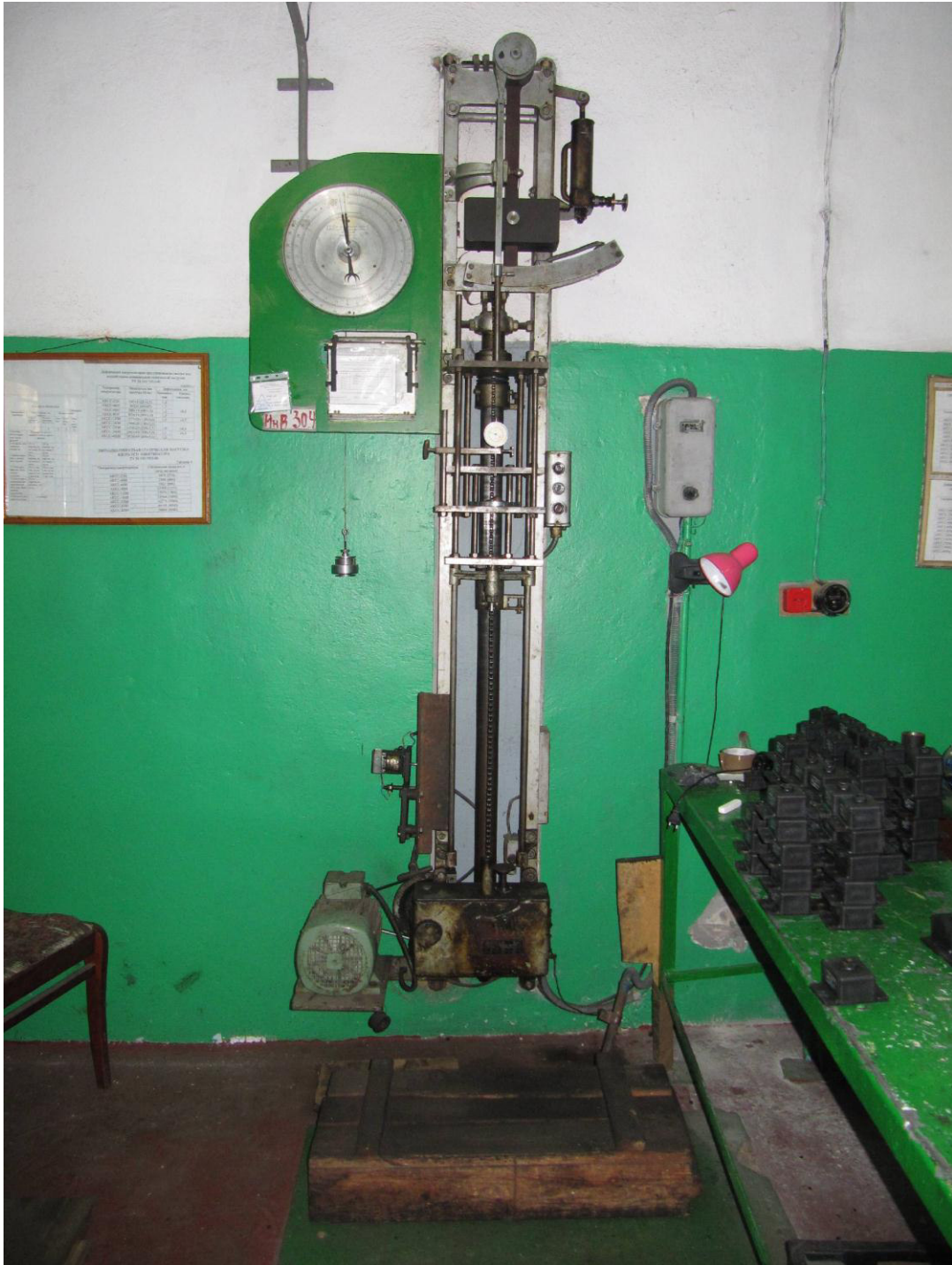
Рисунок 2.21 – Машина для випробування гумометалевих амортизаторів на механічні властивості
