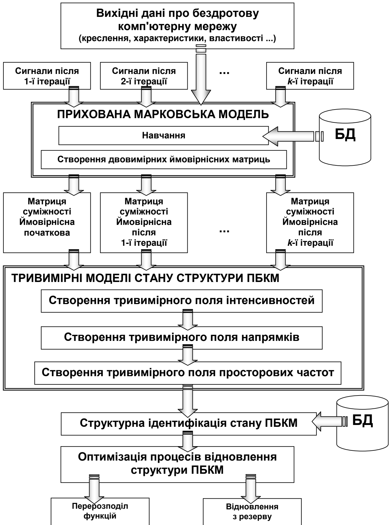
Рисунок 4.1 – Структура системи «OBMIN» ( objects with elements, inaccessible to monitoring ) розпізнавання та відновлення структури частково недоступної для моніторингу пошкодженої БКМ
