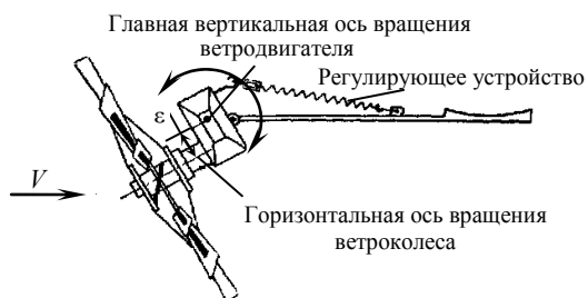
Рис. 1. Регулирование мощности ветродвигателя путем вывода ветроколеса из-под ветра
