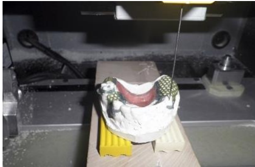
Рисунок 1 – Модель щелепи у 3D-сканері Roland MDX-40R
