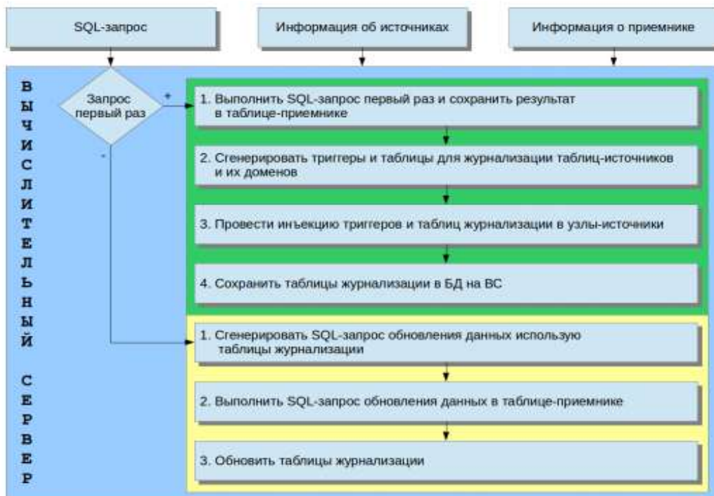
Рисунок 4 – Алгоритм работы ВС с оптимизацией выполнения повторяющегося распределенного запроса в федеративной гетерогенной неоднородной РБД
