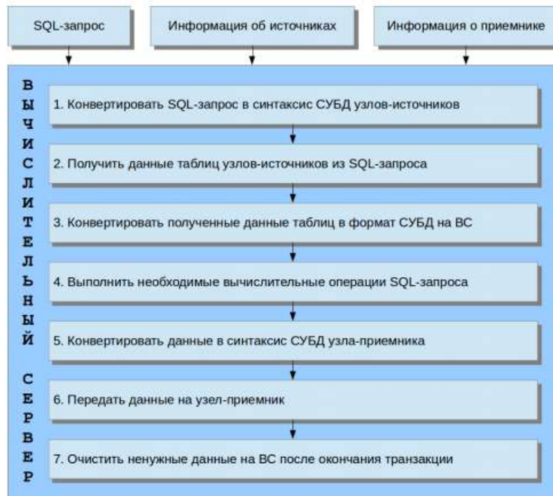
Рисунок 2 – Алгоритм работы ВС с обеспечением гетерогенных свойств узлов в федеративной гетерогенной РБД
