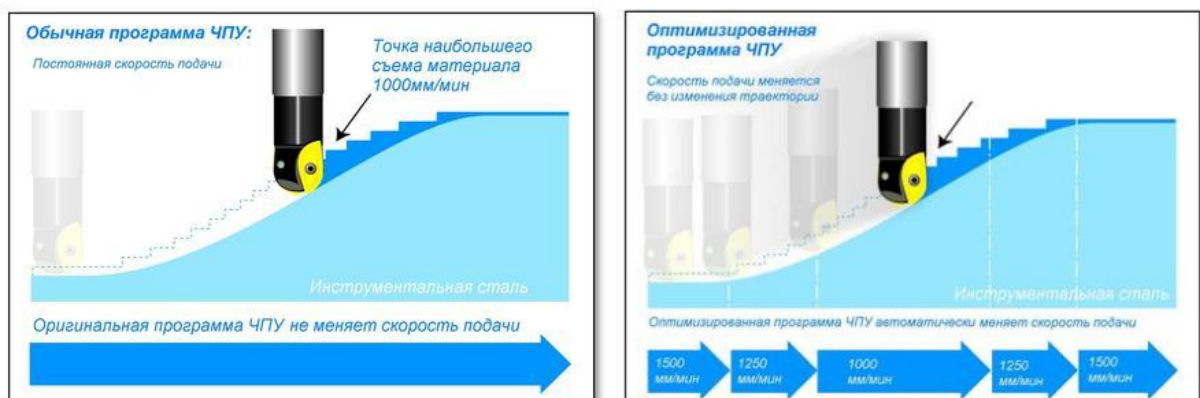
Рис. 1. Приклад взаємодії інструменту та заготовки з оптимізацією параметрів оброблення
