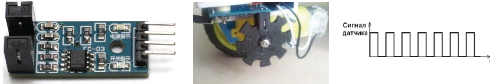
Рис.4. Зовнішній вигляд, схема встановлення, схема видачі імпульсів одометричного датчика, що встановлений на приводному поворотному колесі мобільного роботу з диференціальним приводом.
