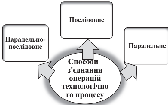
Рисунок 5.5 - Способи з'єднання операцій технологічного процесу
