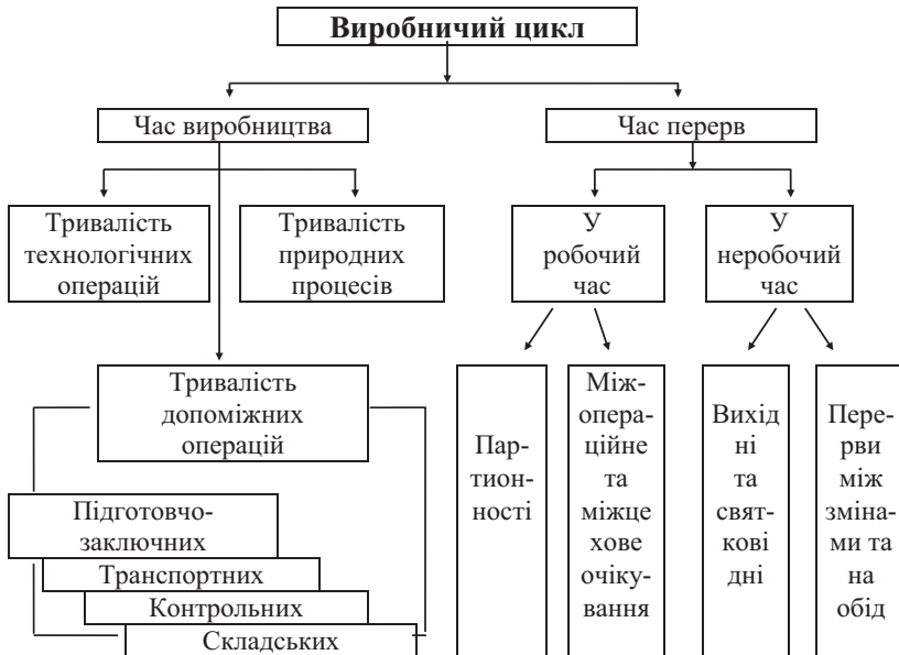
Рисунок 5.4 – Склад виробничого циклу
