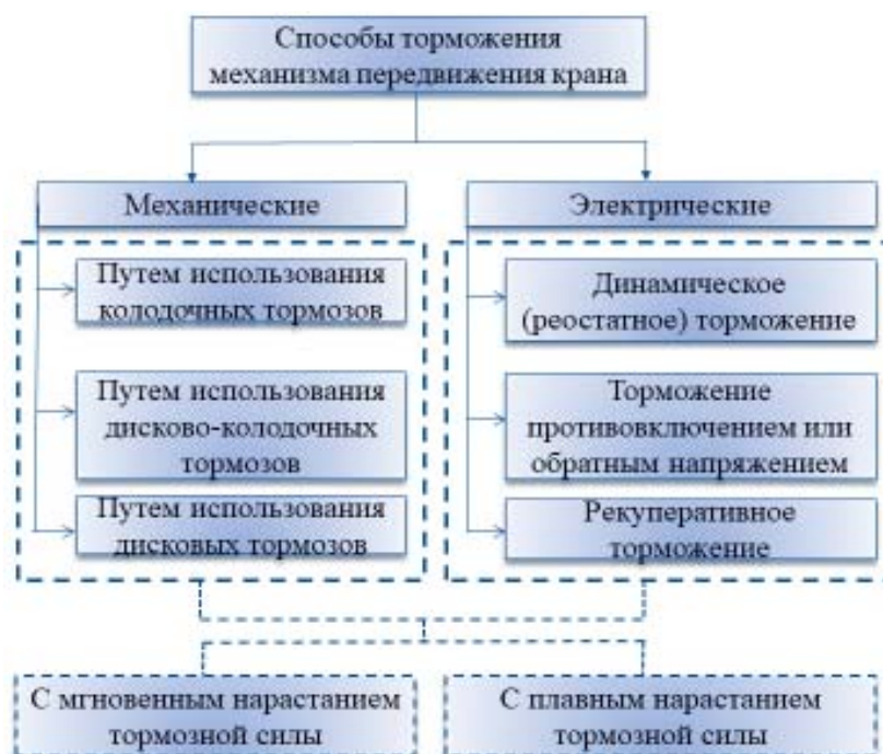
Рис. 1. Классификация способов торможения механизма передвижения мостового крана
